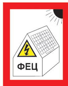
Знак „Фотоволтаична електрическа централа към сграда/постройка“
