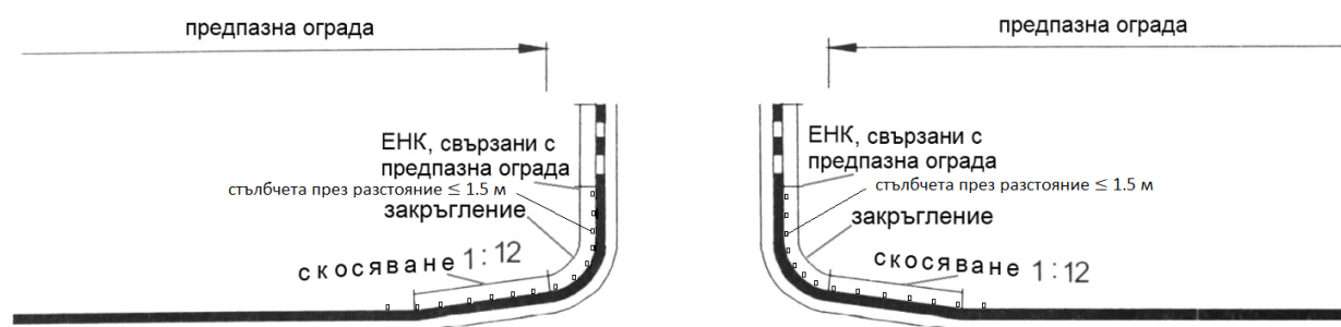
Фиг. 9в. Прекъсване на предпазната ограда, скосена навън 1:12, закръгления и ЕНК
