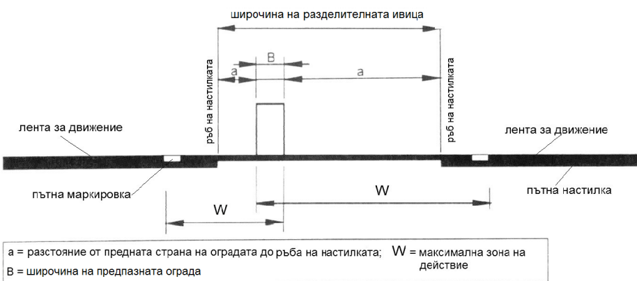
Фиг. 16. Двустранна ограничителна система за пътища, разположена встрани от оста на разделителната ивица
