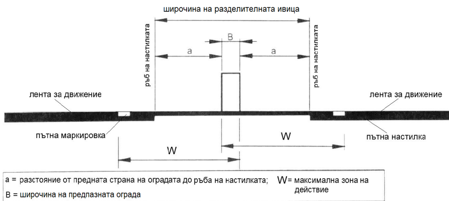
Фиг. 15. Двустранна ограничителна система за пътища, разположена в оста на разделителната ивица
