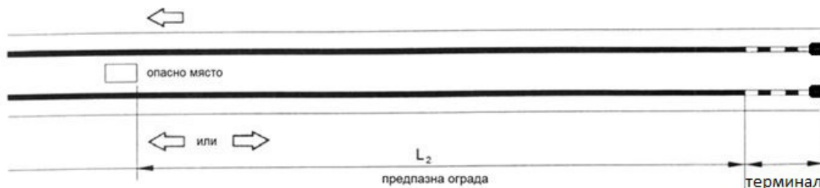
Фиг. 21. Ограничителна система, изградена двустранно в разделителна ивица от едностранна ограничителна система за пътища с единични терминали за начало
